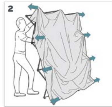
2 Déployez la structure en la penchant légèrement vers l'arrière. Expand the frame vertically while bending it slightly backwards.
